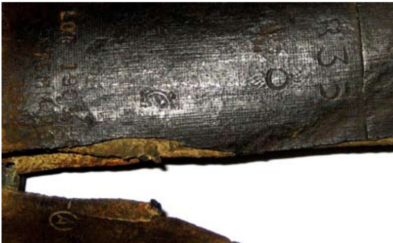
Mynd 4. Myndin sýnir óljóst merki í málminum á ytra byrði sinnepsgassprengjunnar (sbr. mynd 2). Reynt var á sínum tíma að lesa úr þessum merkjum til þess að rekja hvaðan sprengjan væri komin. Myndin er tekin í RLE 20.10.2008.
